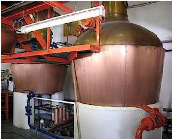
Die Pot Stills sind sehr klein. Die größere Wash Still hat eine Kapazität von 4.200 Litern, die kleine Spirit Still nur von etwa 2.200 Litern. Die Brennblasen, der Maischbottich, die Gärbottiche sowie die Malzmühle sind alle in demselben kleinen Gebäude untergebracht.
